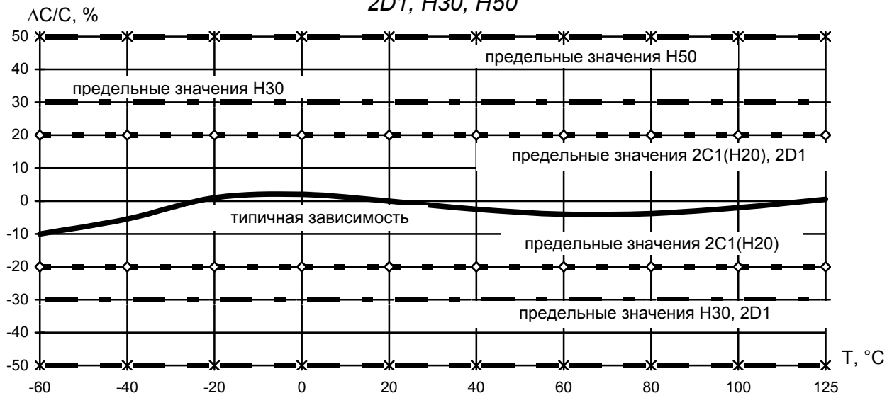
Температурная зависимость изменения емкости групп 2C1 (H20), 2D1, H30, H50
